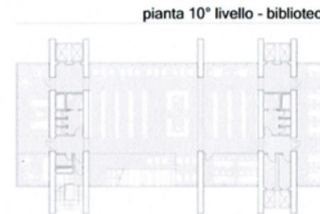
due coppie di lame contengono gli spazi serventi della torre, permettendo la massima versatilità in pianta.
