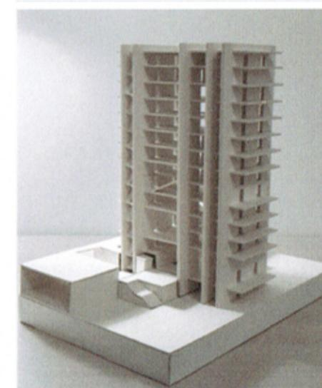
il plastico è realizzato attraverso un sistema ad incastro che permette di nascondere i segni dei tagli e di minimizzare l'uso della colla.
