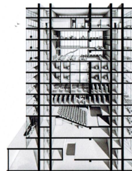
l'edificio si sviluppa a partire da uno schema semplice fatto di elementi verticali portanti ed orizzontali portati, che vengono piegati o sottratti in funzione delle necessità; la facciata denuncia l'articolazione dei livelli.
