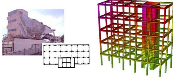
La scarsa conoscenza del comportamento in campo plastico porta le normative a penalizzare questi edifici con fattori di struttura bassi, non fornendo inoltre chiare linee guida per i progettisti.
