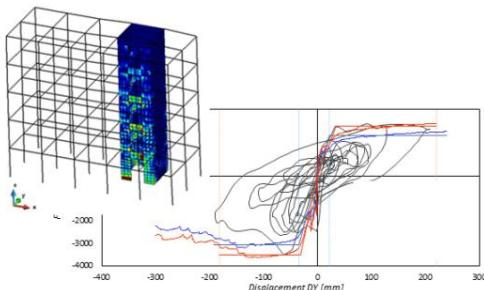
Lo studio numerico, condotto su un campione di edifici rappresentativi del costruito esistente, ha portato ad importanti conclusioni sul comportamento dinamico in campo non lineare e sulle reali capacità dissipative.
